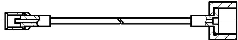
**Таблица А.4 Переходные штуцеры для подключения соединительного шланга с накидной гайкой M16x2**
