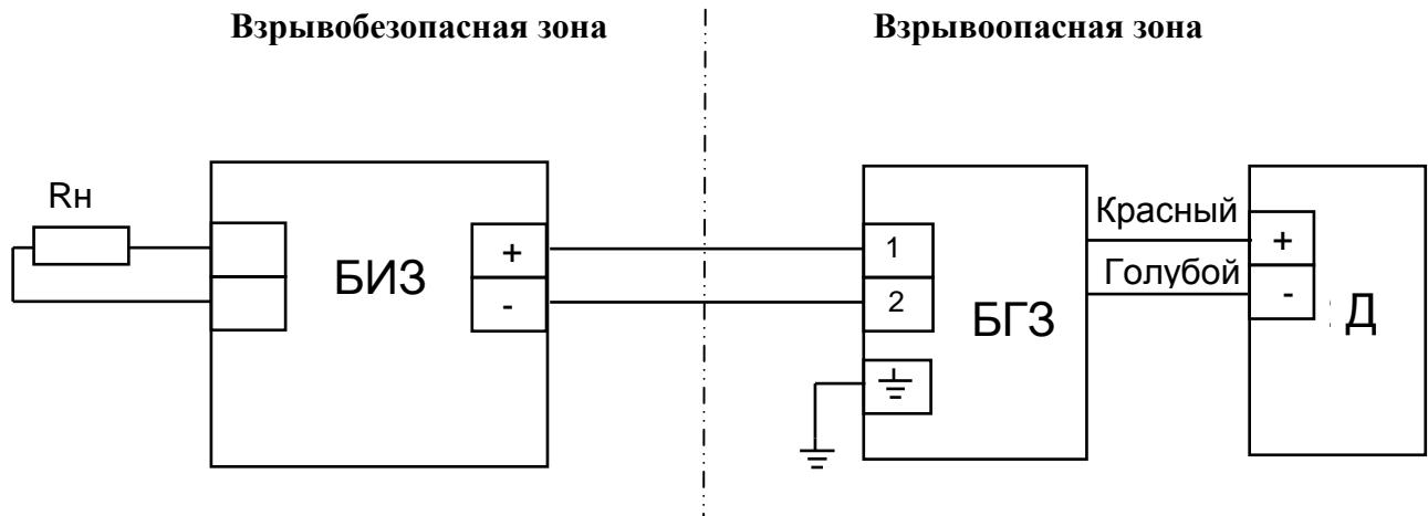
БИЗ – барьер искрозащиты (взрывозащищенный блок питания и преобразования сигналов с видом взрывозащиты «искробезопасная электрическая цепь»);
