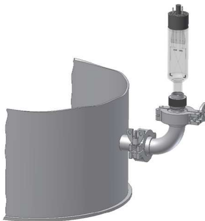
Схема подключения датчика ПМТ-2 к вакуумной системе
