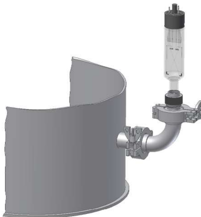
Схема подключения датчика ПМТ-2 к вакуумной системе
