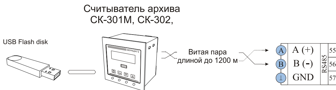
Рис 5.5 Типовая схема подключения прибора к считывателям архива.
