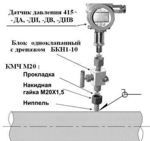
Рисунок Д.1 - Монтаж датчиков моделей 5XX3, 7XX3, 8XX3 и 8XX8
