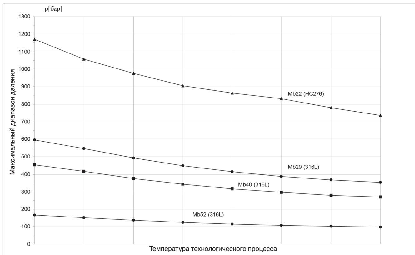
При температуре технологического процесса > +100 °C: следует убедиться в правильности выбранного охлаждающего элемента или капилляра, присоединяемым к измерителю давления
