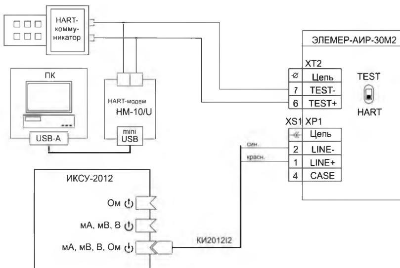
**Рисунок 3.2** - Схема электрическая подключений ЭЛЕМЕР-AИР-30М с выходным сигналом 4-20 мА без каналов сигнализации с разъемами ШР-14, ШР-22 к ИКСУ-2012
