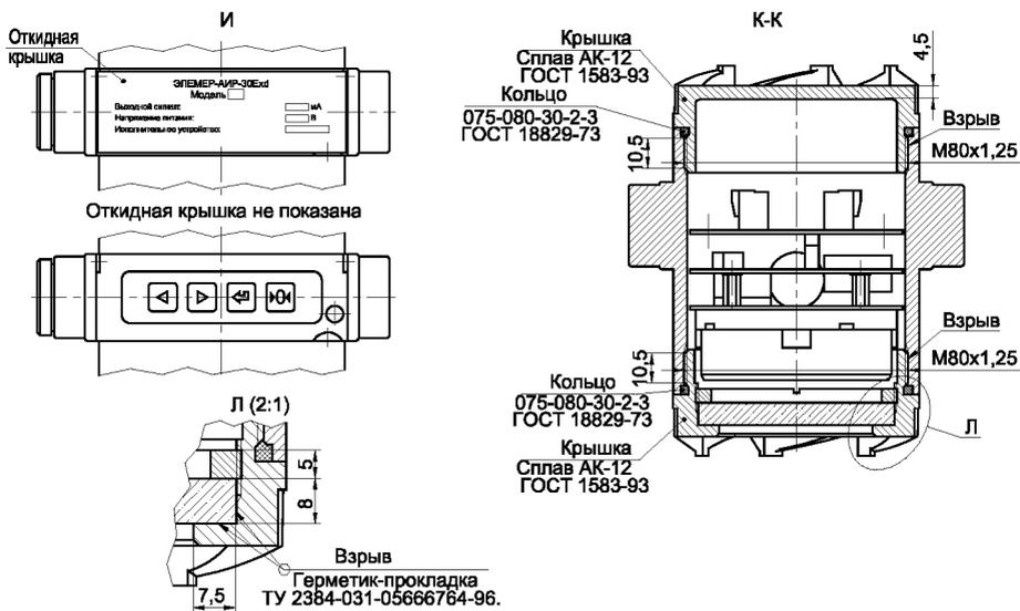
Рисунок А.11 - Чертеж средств взрывозащиты
