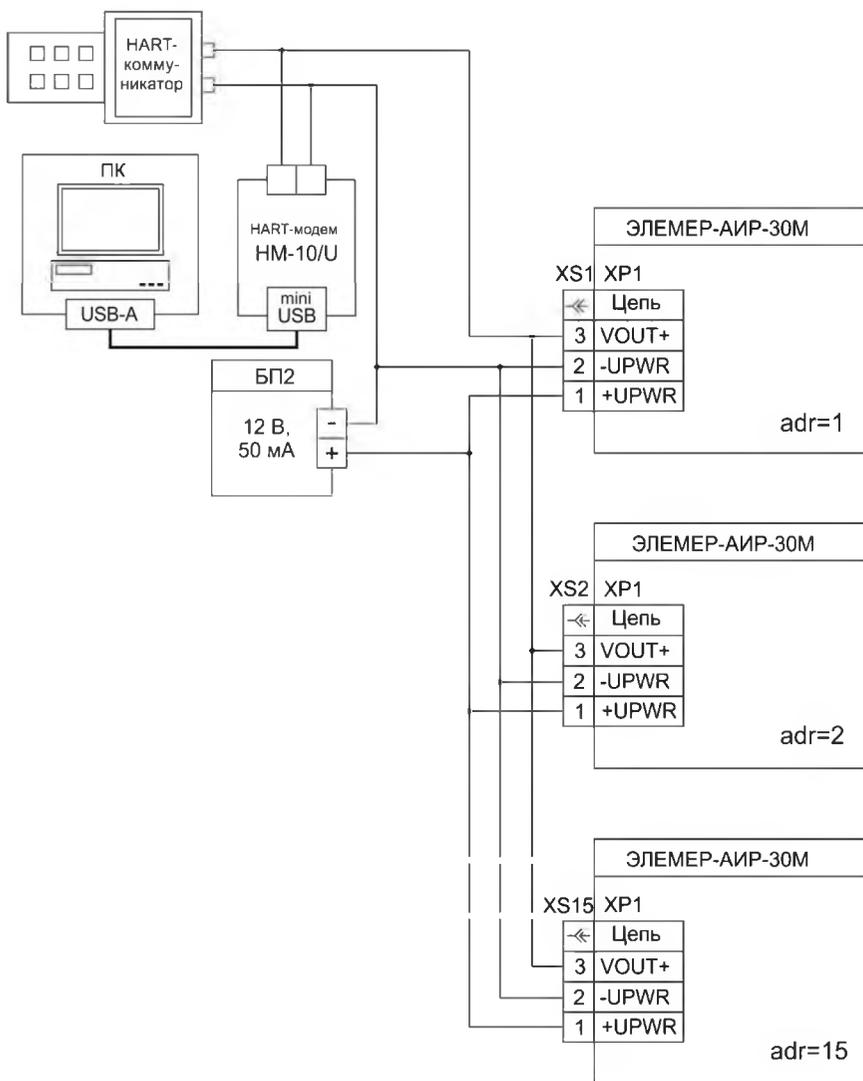
**Рисунок 3.28** - Схема электрическая подключений ЭЛЕМЕР-АИР-30М с выходными сигналами 0,8-3,2 В; 0,5-4,5 В; 1-5 В с разъемами ШР-14 ШР-22 при многоточечном режиме работы по HART-протоколу
