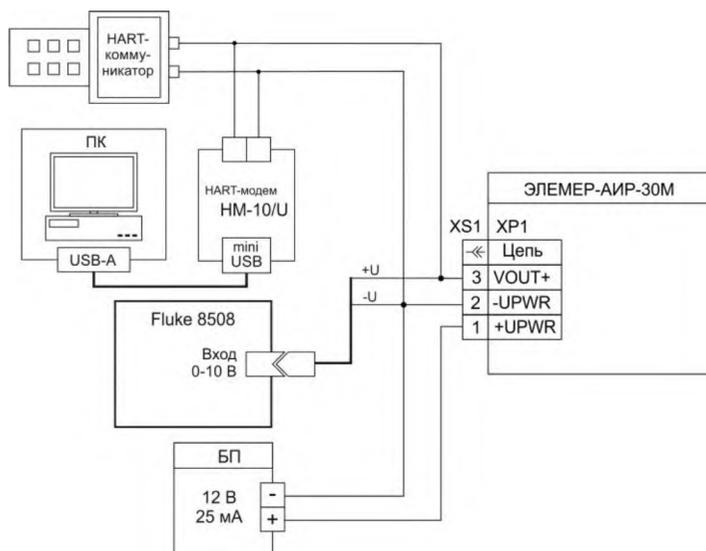
**Рисунок 3.6** - Схема электрическая подключений ЭЛЕМЕР-АИР-30М с выходными сигналами по напряжению 0,8-3,2 В; 0,5-4,5 В; 1-5 В с разъемами ШР-14, ШР-22
