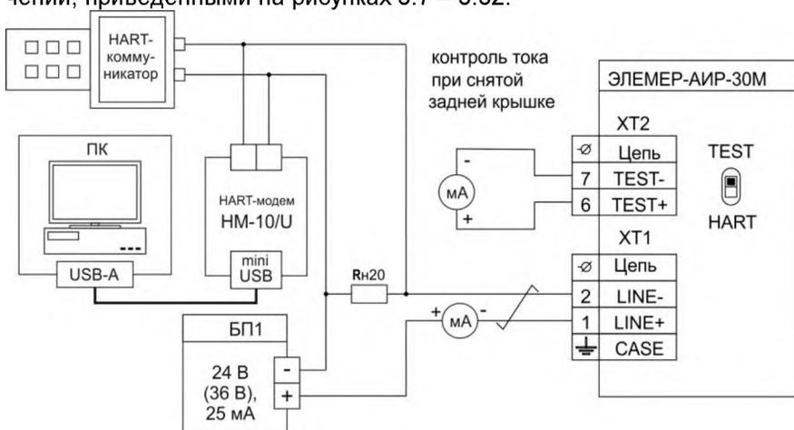
**Рисунок 3.7** - Схема электрическая подключений ЭЛЕМЕР-АИР-30М
