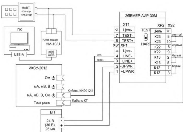
**Рисунок 3.4.2-** Схема электрическая подключений ЭЛЕМЕР-АИР-30М с выходным сигналом 0-5 мА с каналами сигнализации на электромагнитных реле с разъемами ШР-14, ШР-22
