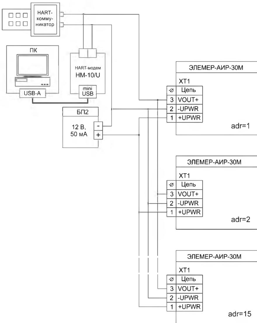
**Рисунок 3.27** - Схема электрическая подключений ЭЛЕМЕР-АИР-30М с выходными сигналами 0,8-3,2 В; 0,5-4,5 В; 1-5 В с кабельным вводом при многоточечном режиме работы по HART-протоколу
