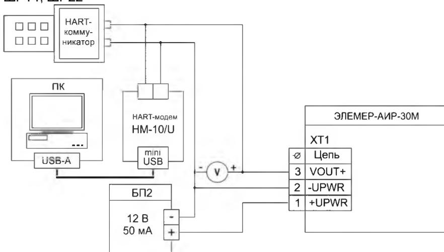
**Рисунок 3.9** - Схема электрическая подключений ЭЛЕМЕР-АИР-30М с выходными сигналами по напряжению 0,8-3,2 В; 0,5-4,5 В; 1-5 В с кабельным вводом
