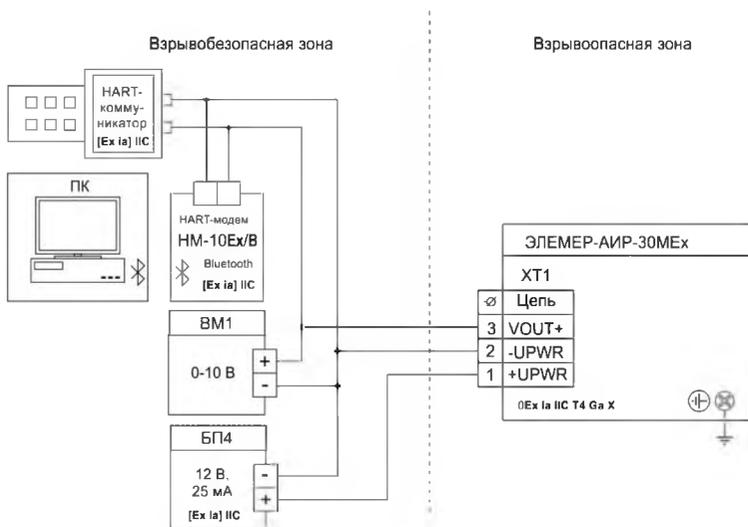
**Рисунок 3.31** - Схема электрическая подключений ЭЛЕМЕР-АИР-30МEx с выходными сигналами 0,8-3,2 В; 0,5-4,5 В; 1-5 В с кабельным вводом
