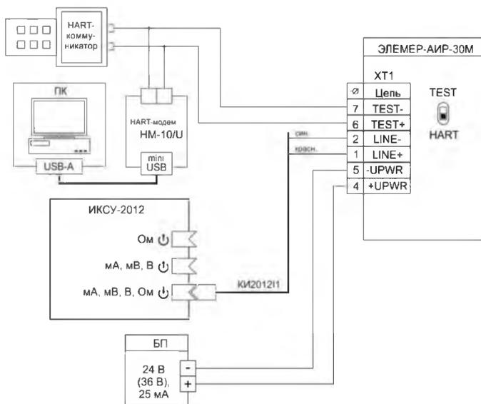
**Рисунок 3.3** - Схема электрическая подключений ЭЛЕМЕР-АИР-30М с выходным сигналом 0-5 мА без каналов сигнализации с кабельным вводом
