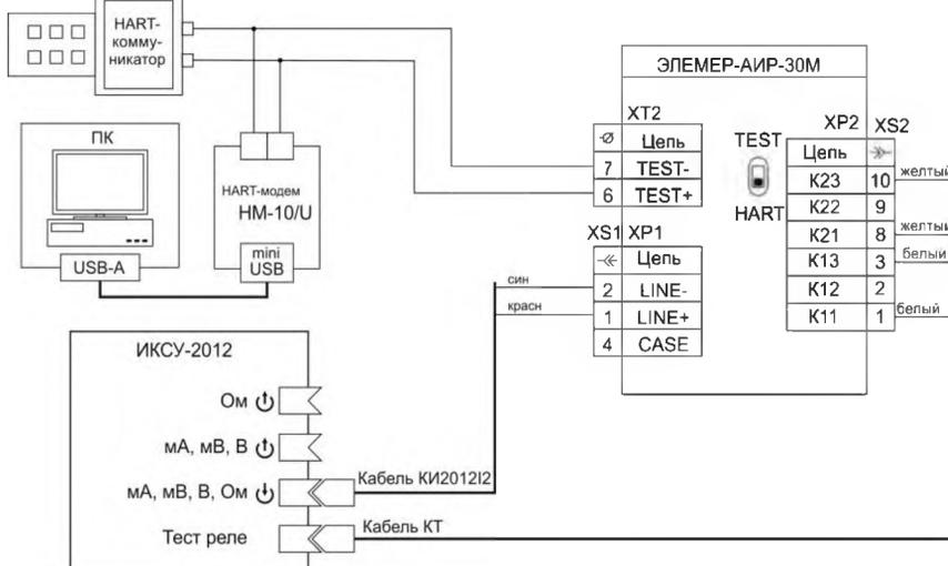
**Рисунок 3.2.1** - Схема электрическая подключений ЭЛЕМЕР-AИР-30М с выходным сигналом 4-20 мА с каналами сигнализации на оптореле с разъемами ШР-14, ШР-22 к ИКСУ-2012
