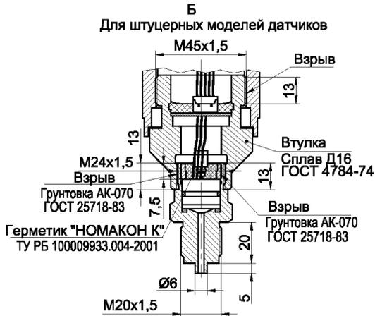
Рисунок А.12 - Чертеж средств взрывозащиты
