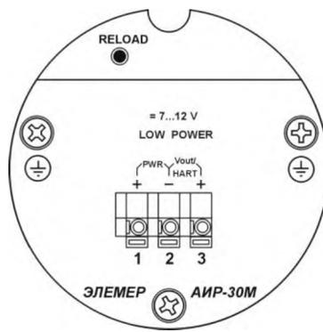
**Рисунок 2.7** - Модуль подключений АИР-30М с выходными сигналами напряжения 0,8-3,2 В; 0,5-4,5 В; 1-5 В
