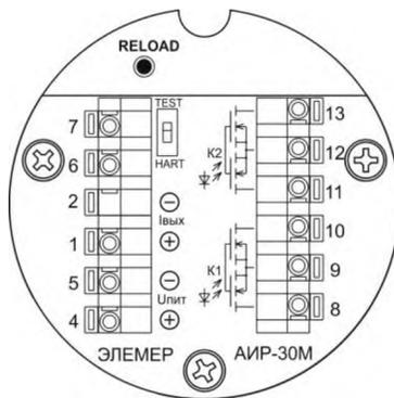
**Рисунок 2.9** - Модуль подключений АИР-30М с выходным сигналом 0-5 мА с оптореле
