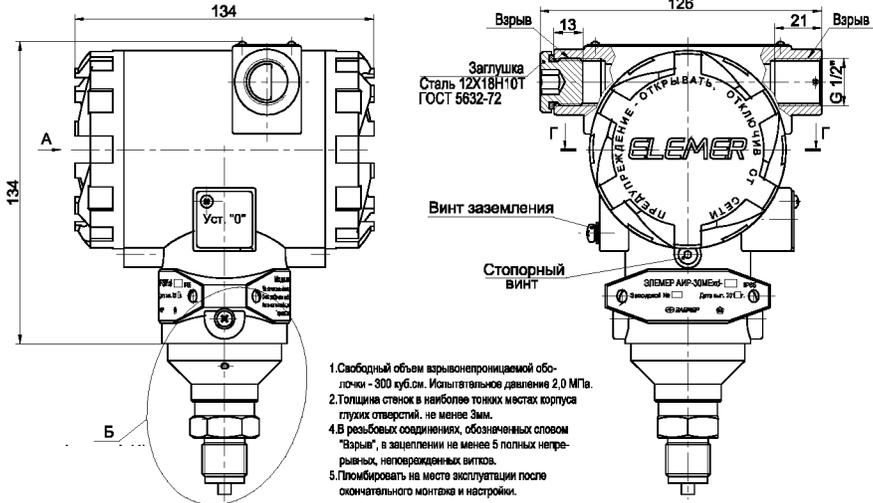
Рисунок А.6 - Чертеж средств взрывозащиты
