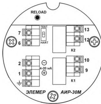
**Рисунок 2.5** - Модуль подключений АИР-30М с выходным сигналом 4-20 мА и электромагнитными (поляризованными) реле
