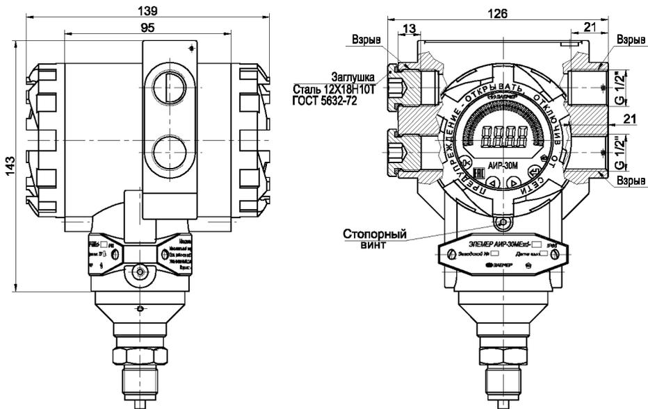
Рисунок А.10 - Чертеж средств взрывозащиты
