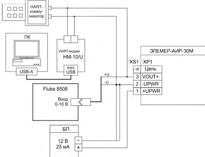
**Рисунок 3.5 -** Схема электрическая подключений ЭЛЕМЕР-АИР-30М с выходными сигналами по напряжению 0,8-3,2 В; 0,5-4,5 В; 1-5 В с кабельным вводом
