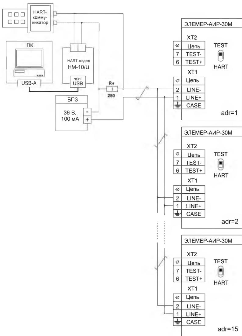
**Рисунок 3.25** - Схема электрическая подключений ЭЛЕМЕР-АИР-30М с выходным сигналом 4-20 мА с кабельным вводом при многоточечном режиме работы по HART-протоколу (каналы сигнализации не показаны, но могут присутствовать)
