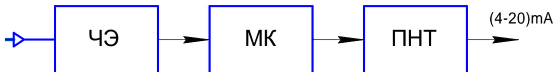
Рис.1 Структурная схема датчика.
