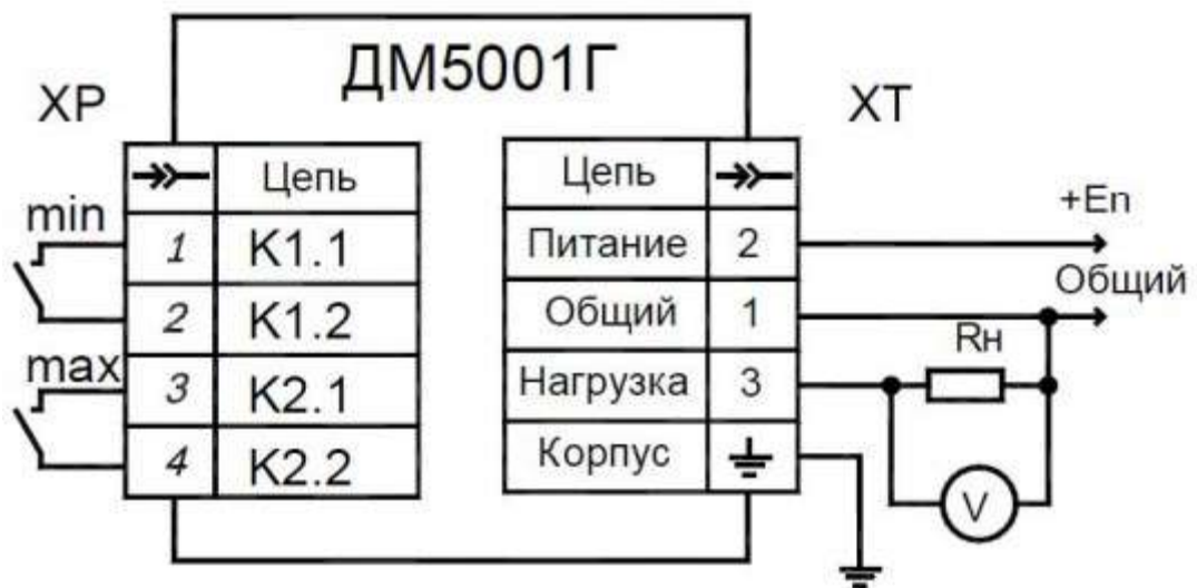
Рисунок Г.2 – прибор ДМ5001Г
