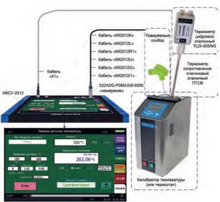
**Поверка вторичных приборов**. Данный режим предназначен для проверки точности работы измерительных преобразователей и других аналогичных приборов. Сигнал, эмулируемый ИКСУ-2012, подается на вход испытуемого при-бора, который формирует на выходе унифицированный сигнал, далее сигнал поступает на измерительный вход ИКСУ-2012, преобразуется в физическую величину по заданному пользователем закону, и результат выводится на дисплей.
