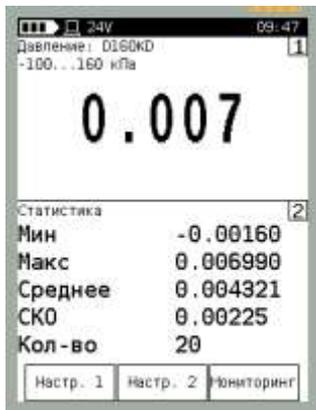
При этом на дисплее калибратора отображаются следующие параметры:
