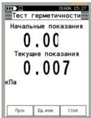
Воспроизвести давление, равное ВПИ поверяемого датчика, выдержать под давлением поверяемый прибор в течение 3-5 минут для стабилизации термодинамических процессов.
