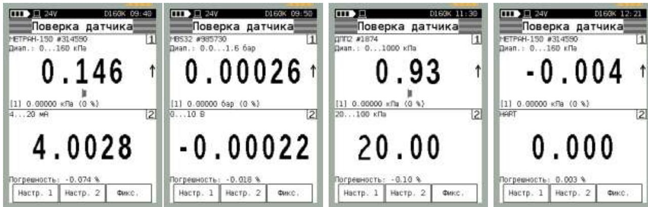
2.6.1.6 Для обнуления показаний первого канала измерения (давления) следует нажать кнопку «Настр. 1». При этом калибратор переходит в меню, в котором отображается текущее измеренное давление и коэффициент усреднения:
