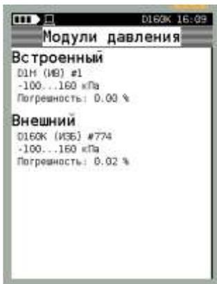
**ВНИМАНИЕ: ПРИ ПОВЕРКЕ ПНЕВМАТИЧЕСКИХ ПРЕОБРАЗОВАТЕЛЕЙ ДАВЛЕНИЯ НЕОБХОДИМО НАЛИЧИЕ ВСТРОЕННОГО И ВНЕШНЕГО МОДУЛЕЙ ДАВЛЕНИЯ!**
