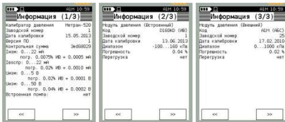
Для пролистывания информации следует нажимать на кнопки «<<» и «>>». Если внешний модуль не подключен, то окно «Информация 3/3» не отображается.
