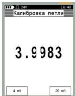
Для установки 4 мА (20 мА) следует нажать кнопку «4 мА» («20 мА»). При этом калибратор посылает команду датчику на установку соответствующего выходного токового сигнала и производит измерение выходного сигнала:
