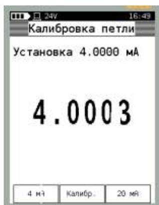
Для корректировки показаний следует нажать кнопку «Калибр.» и повторить алгоритм коррекции выходного сигнала на другой точке (20 мА).
