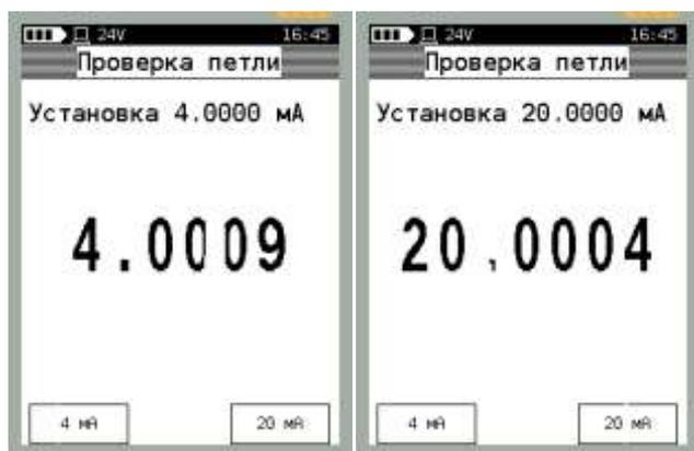
При нажатии на кнопки «4 мА», «20 мА» датчику отсылается команда на установку силы постоянного тока равного 4 и 20 мА соответственно, калибратор при этом производит измерение выходного сигнала.
