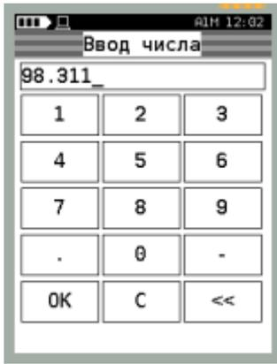
2.9.10.3 После обнуления показаний модуля давления на атмосферном давлении следует установить на эталоне давление, равное ВПИ модуля давления. После выдержки модуля под давлением выбрать команду «Калибровать Р». При этом калибратор запросит ввести эталонное давление на входе модуля и подтвердить ввод нажатием кнопки «Ок»:
