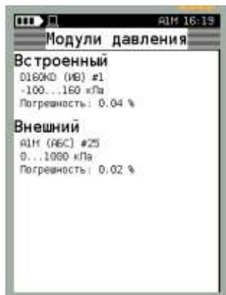
После определения настроек первого и второго канала калибратор переходит в режим измерений. В качестве примера показан случай выбора внешнего модуля давления А1М на первом канале измерения, встроенного модуля давления D160К на втором канале измерения:
