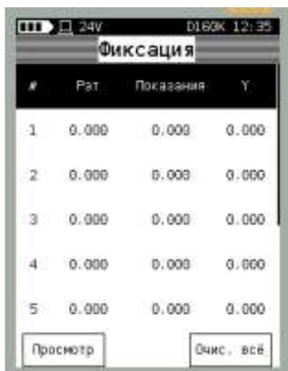
На дисплее калибратора отображается пролистываемый список с зафиксированными показаниями поверяемого датчика:
