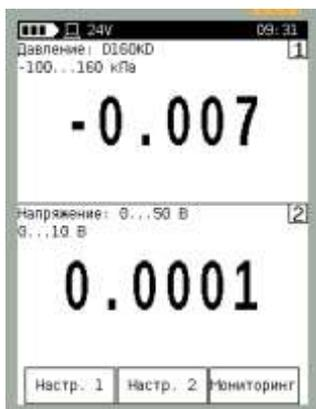
Для настройки канала измерения давления следует нажать кнопку «Настр. 1» (см. п. 2.7.3.1), для настройки канала измерения напряжения следует нажать кнопку «Настр. 2»:
