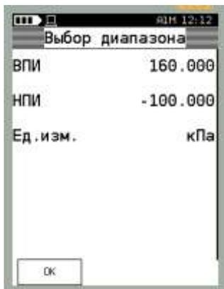
2.9.10.2 Для калибровки модуля давления следует подключить его пневматический выход к эталону давления, установить атмосферное давление и произвести обнуление модуля давления, выбрав соответствующую команду «Обнулить Р»:
