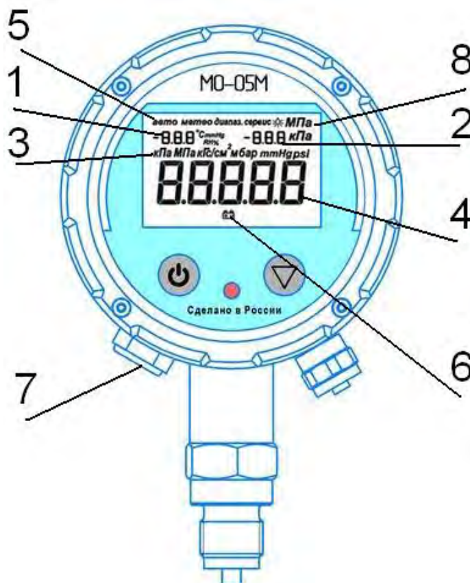
Рисунок 3. Внешний вид МО-05М с ЖК дисплеем, не съемной ИГ и установленной МС
