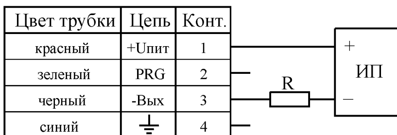
Рисунок А.1 – Схема подключения преобразователя
